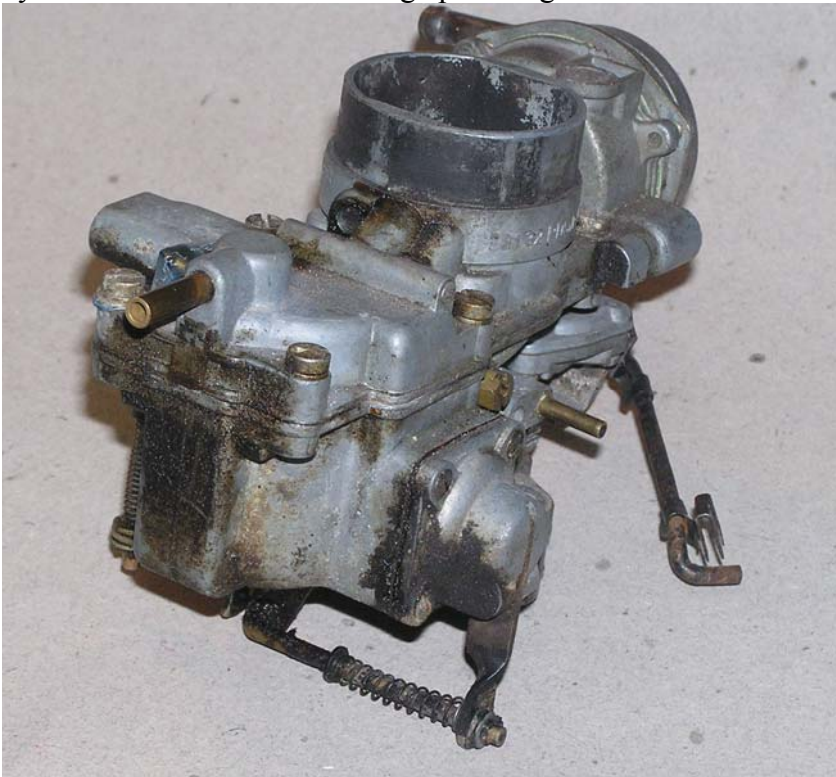
Förgasare före demontering och rengöring.
