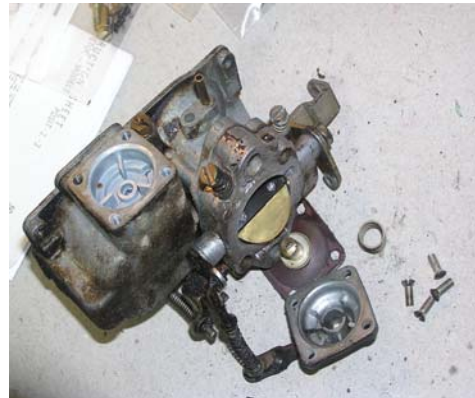
Demontering av acc-pump
